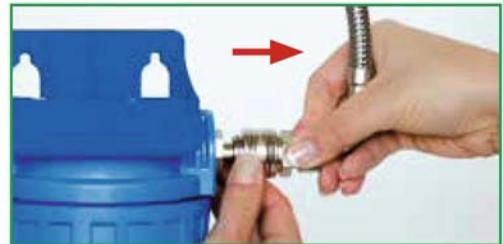
2. Schiebehülse (Entriegelung) in Pfeilrichtung schieben und festhalten.
