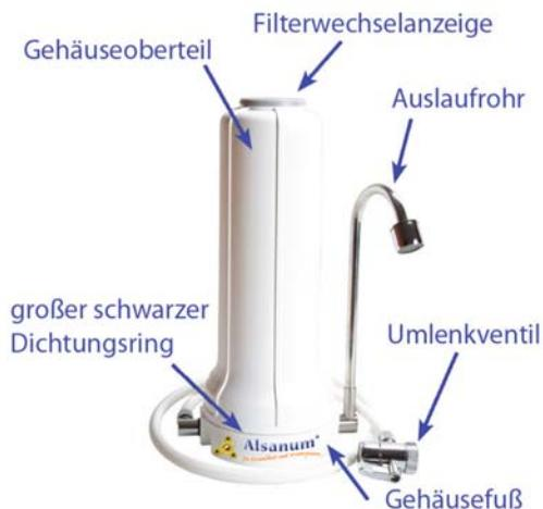
1. Damit das Gehäuse leicht zu öffnen ist, gehen Sie wie folgt vor: Nehmen Sie den Filter in Betrieb und lassen Sie das Wasser kurz laufen. Stellen Sie die Wasserzufuhr ab und drehen Sie anschließend den Hebel am Umlenkventil so, dass er sich mittig (zwischen waagrecht und senkrecht) befindet.
